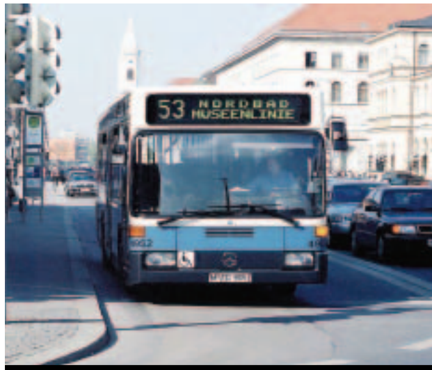
So sähe eine gut lesbare und sehbehindertengerechte Beschriftung aus.
