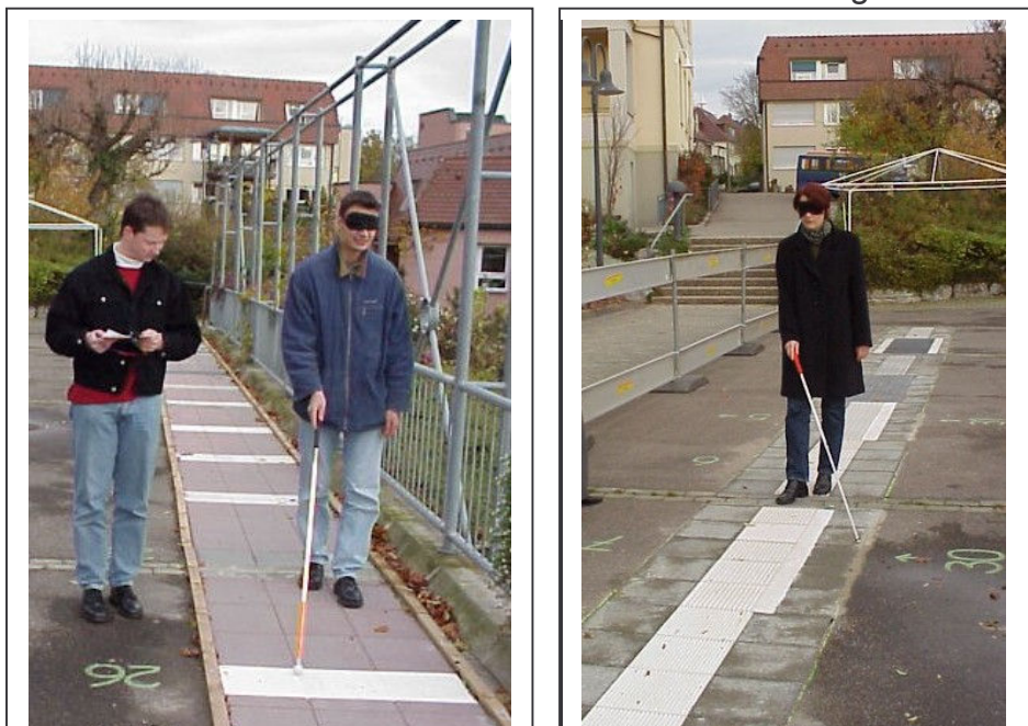
Abb. 2: Architekturstudenten beim Erleben der Teststrecke. Der Streifen mit längs verlaufenden, aneinandergereihten Bodenindikatoren dient dem Test der Leitfunktion, der Streifen mit kurzen quer verlaufenden Bodenindikatorenreihen dem Test der Aufmerksamkeitsfunktion.
